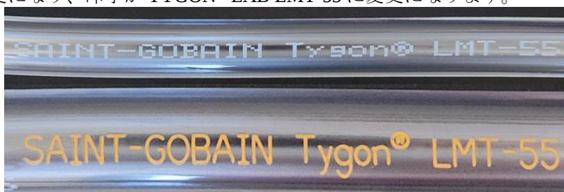
インクジェットプリンターによる印字例（上）とレーザーマーカーによる印字例（下）
