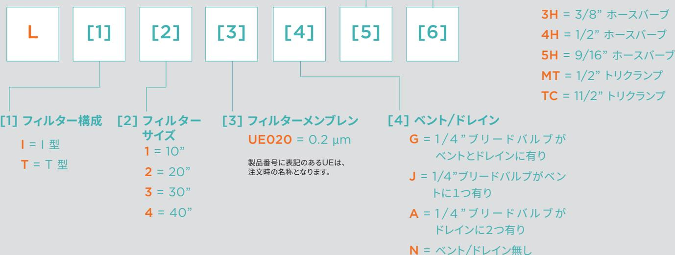
(1) I型カプセルの場合、入口に最も近いバルブです。T型カプセルの場合、カプセルの「上」にあり、入口/出口継手から最も遠いバルブです。
