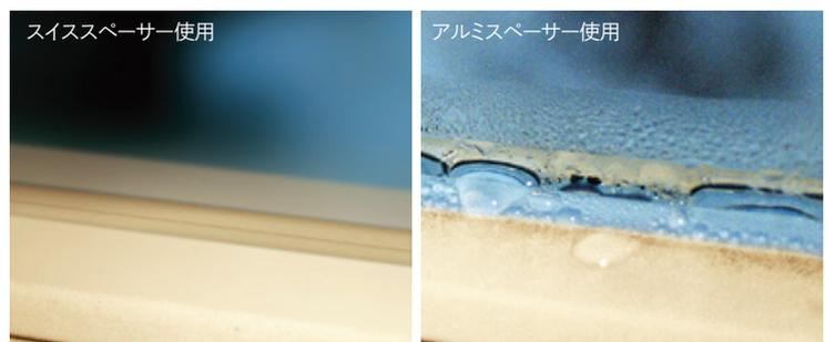
通常の窓では、低温状態でガラスの周辺部に結露が発生します。スイスペーサーを使用すると、従来のアルミスペーサーに比べて結露の発生を大幅に抑え、カビの発生も抑制します
